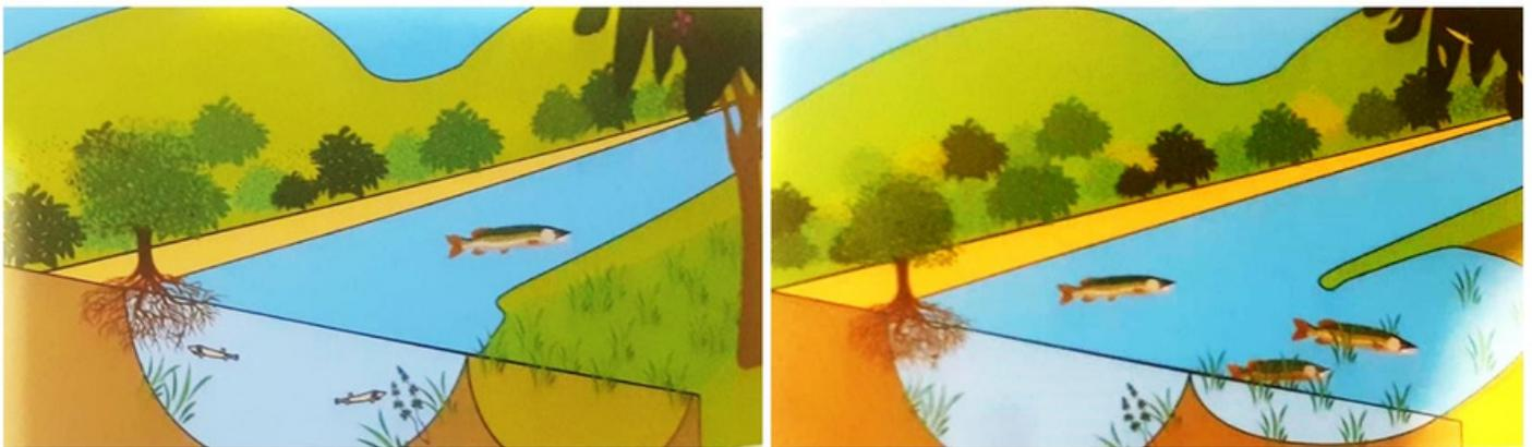
*Schéma illustrant la complémentarité piscicole chenal / plâtis et l'intérêt des travaux de diversification en marge du chenal navigable*
